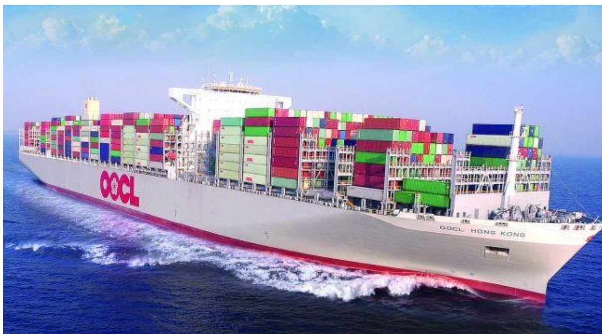
Slika 13: Najveći kontejnerski brod današnjice, kapaciteta 21.413 kontejnera (2020.) [14]
