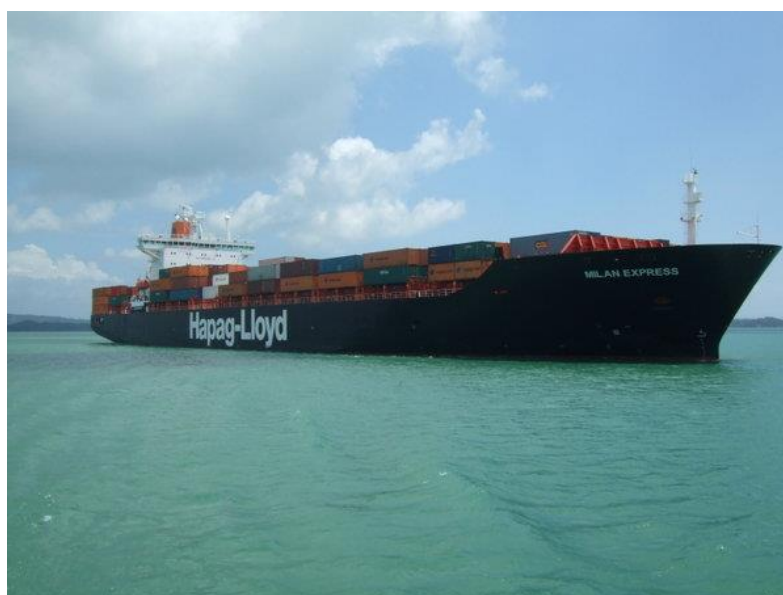
Slika 8.: Panamax kontejnerski brod [13]
