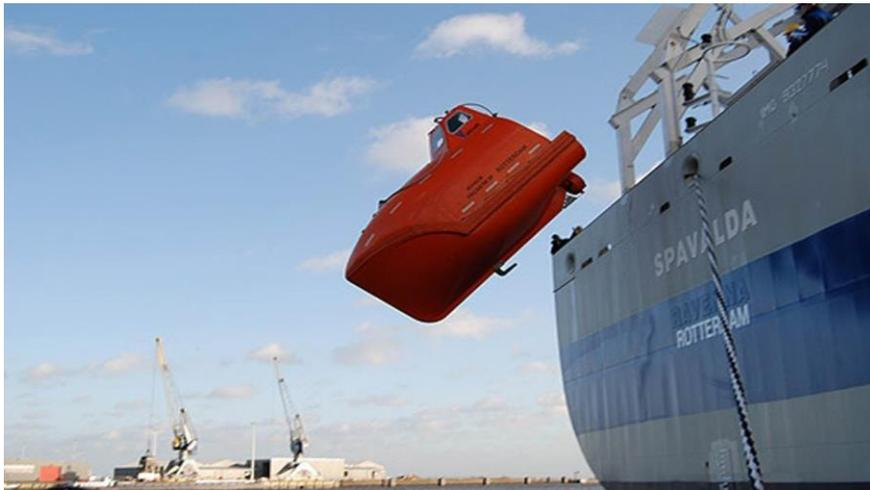
Slika 7. Spasilačka brodica sa spuštanjem na slobodni pad
