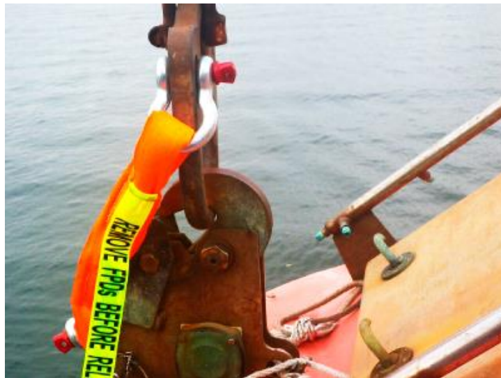
Slika 17. Uređaj za zaštitu od pada brodice – FPD
