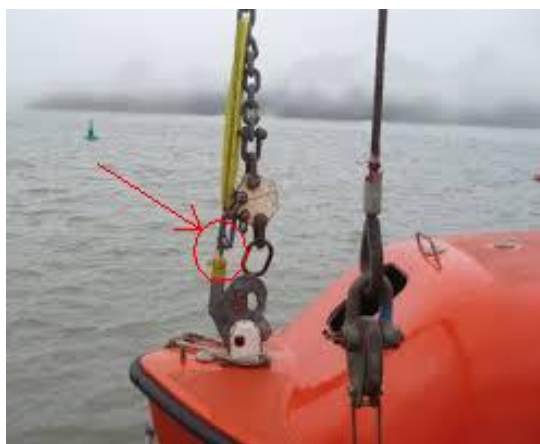
Slika 16. Ue za vješanje brodice prilikom održavanja kuka
