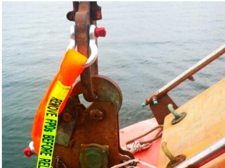
Slika 17. Uređaj za zaštitu od pada brodice – FPD
