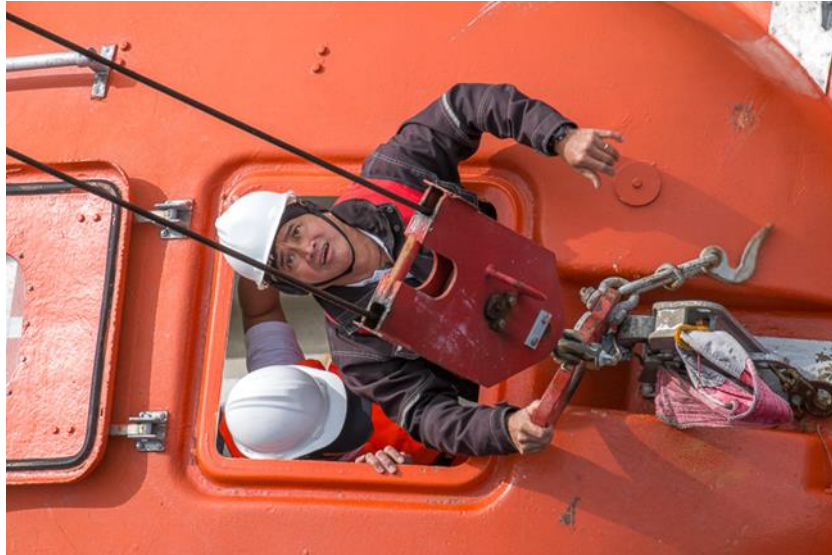
Slika 20. Član posade tijekom vježbe napuštanja broda spaja kuku i blok čelik-čela
