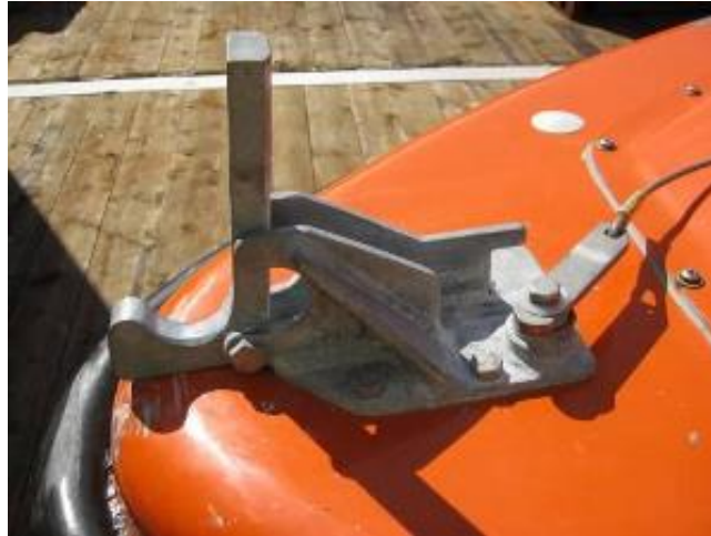
Slika 3. Uređaj za otpuštanje pramčanog konopa brodice za spašavanje
