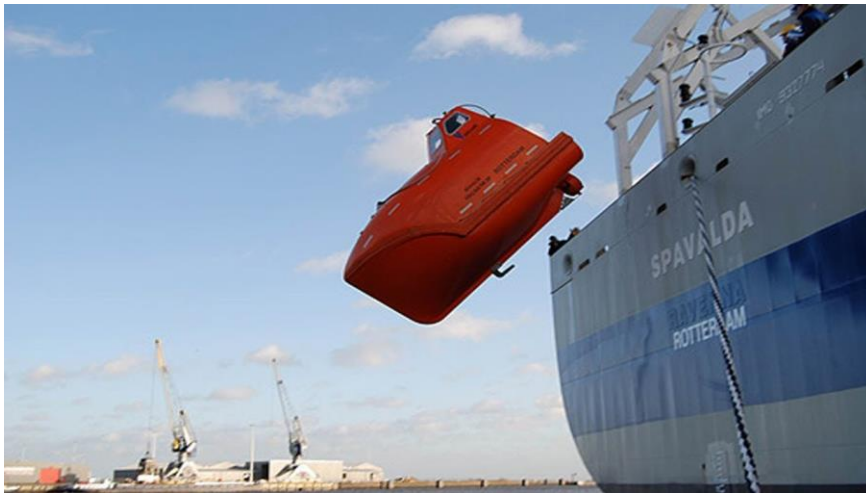
Slika 7. Spasilačka brodica sa spuštanjem na slobodni pad
