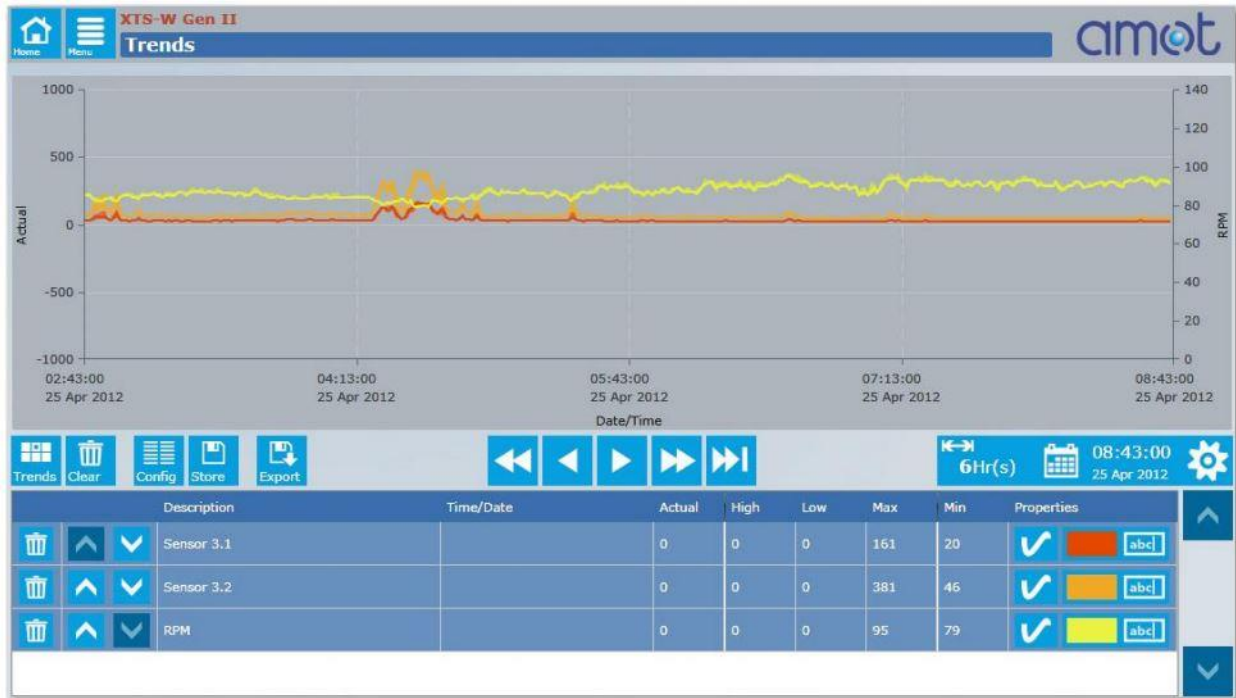
Slika 25. Prikaz krivulja dvaju mjerenja senzora i krivulje broja okretaja (Izvor: AMOT software manual)
