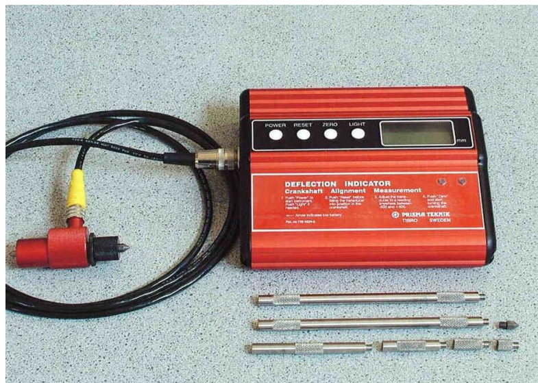
Slika 54. Mjerač otklona s produžecima i jedinicom za spajanje na računalo (Izvor: Deflection indicator manual PC)
