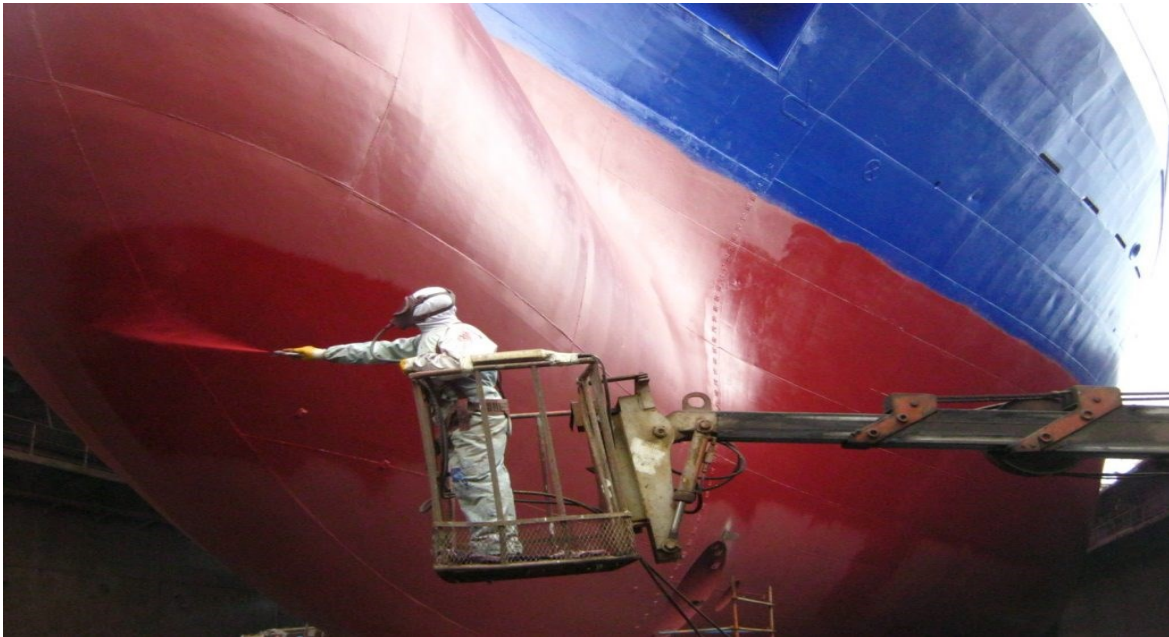
Slika 13. Nanošenje antivegetativno premaza na oplatu broda; Izvor [14]
