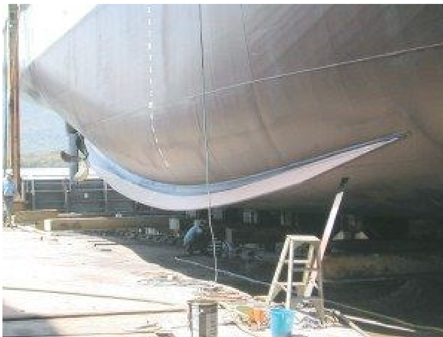
Slika 9. Prikaz kaljužne kobilice u dokovanju broda; Izvor [8].
