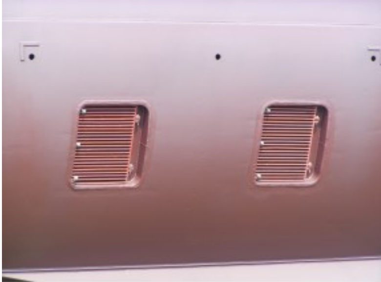
Slika 14. Prikaz brodskih kutija za usis mora s zaštitnim rešetkama; Izvor [10]
