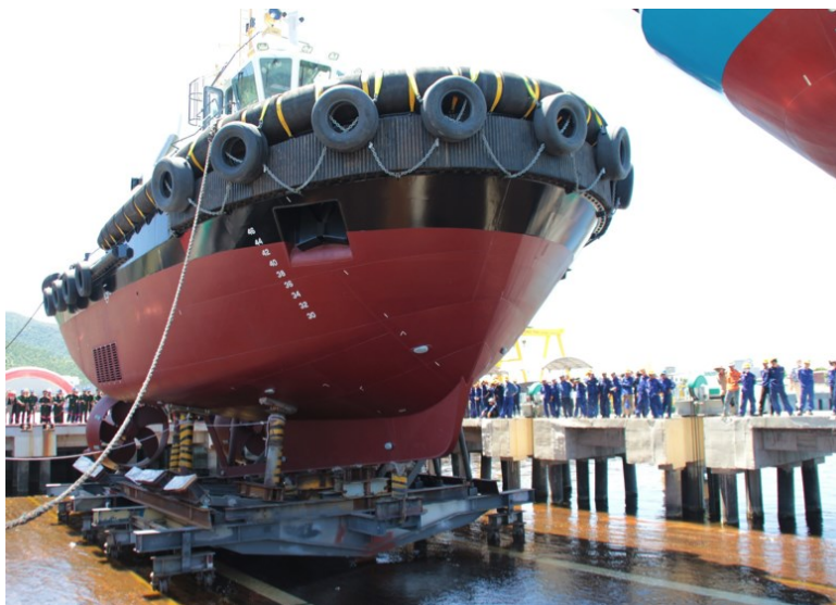
Slika 4. Prikaz rada brodskog lifta (engl.shiplift) ; Izvor [5]
