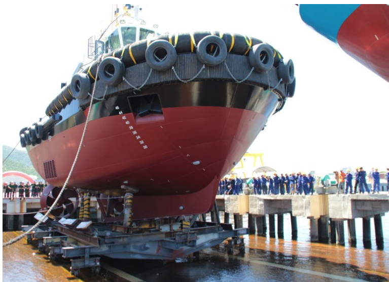
Slika 4. Prikaz rada brodskog lifta (engl.shiplift) ; Izvor [5]
