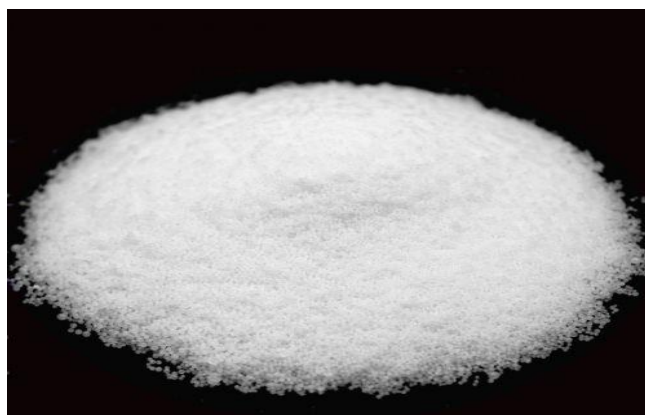
Slika 20: kaustična soda koja se koristi za tretiranje slatke vode u scrubberima zatvorene petlje (preuzeto: https://camachem.com/en/caustic-soda-pearls-99-sodium-hydroxide-pearls99.html Caustic Soda Pearls 99%)
