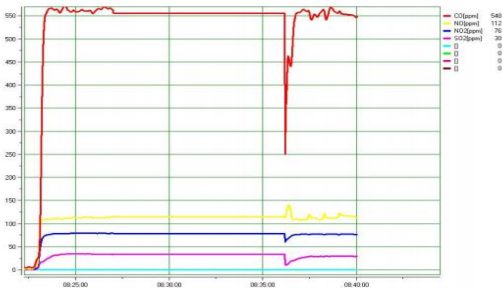
Grafikon 5: prikaz izmjerenih vrijednosti CO, NO, NO 2 i SO 2 za desni motor broda DBM-82 Krka (izvor: Duje Zoko, 2018., Mjerenje ispušnih emisija brodskog motora )
