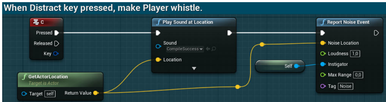
Primjer 17. Blueprint za puštanje zvuka na igračevoj lokaciji
