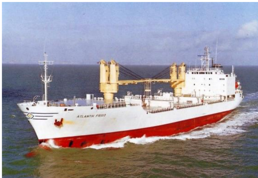
Slika 2. Brod za prijevoz rashlađenog tereta, frigo brod 4
