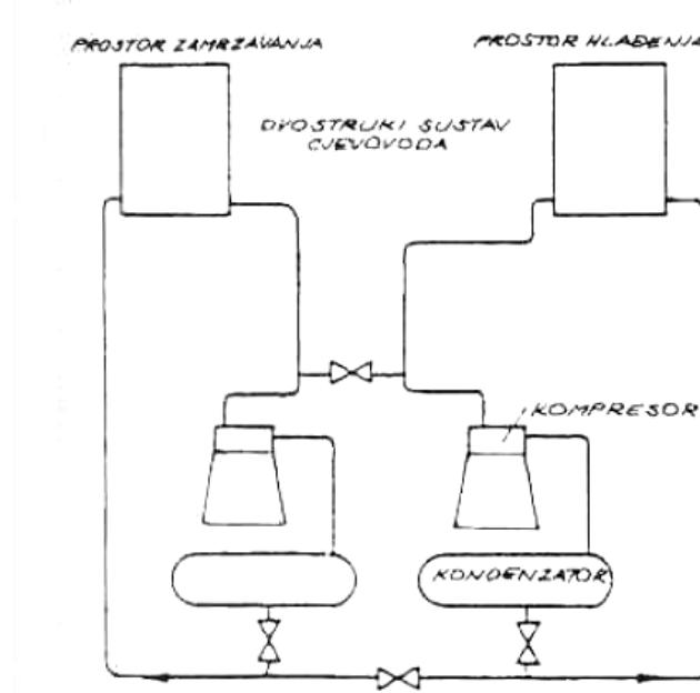
Slika 10. Dvostruki sustav cjevovoda<sup>36</sup>
