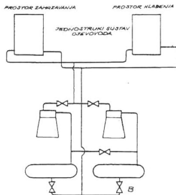
Slika 11. Jednostruki sustav cjevovoda<sup>37</sup>
