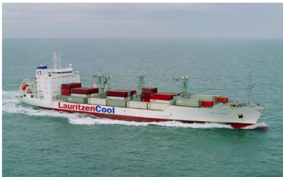
Slika 4. Konvencionalni brod hladnjača „Lady Račišće“, izgrađen 2000. godine, ukupnog kapaciteta hlađenog prostora od 17.000 m 3 i 260 TEU 16
