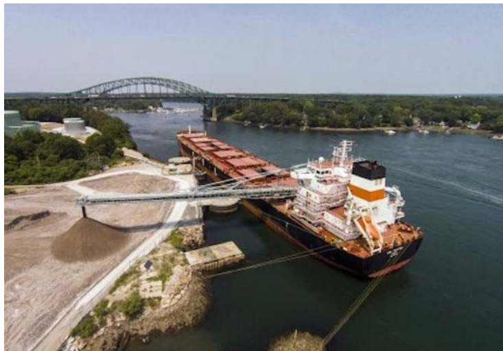
Slika 17. Brod samostalno iskrcava teret ( self unloader ).
