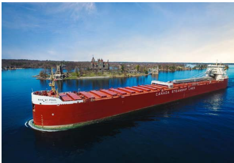
Slika 18. Brod namijenjen plovidbi isključivo velikim jezerima ( laker ).
