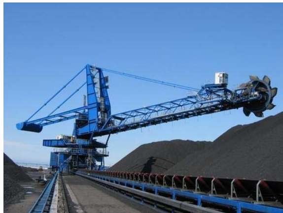
Slika 26. Uređaj za slaganje i povrat tereta.
