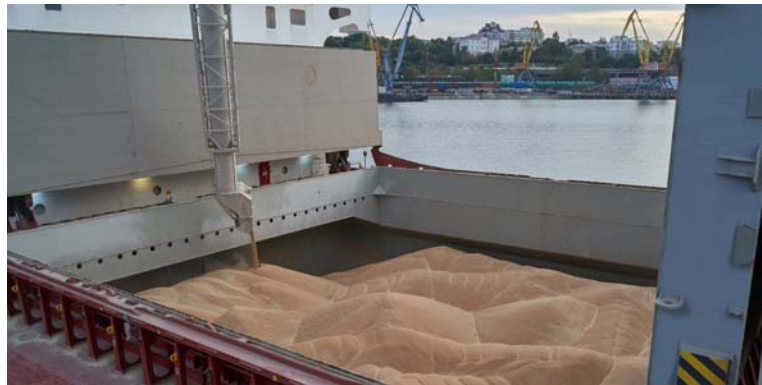
Slika 7. Ukrcaj žita u brodsko skladište broda.
