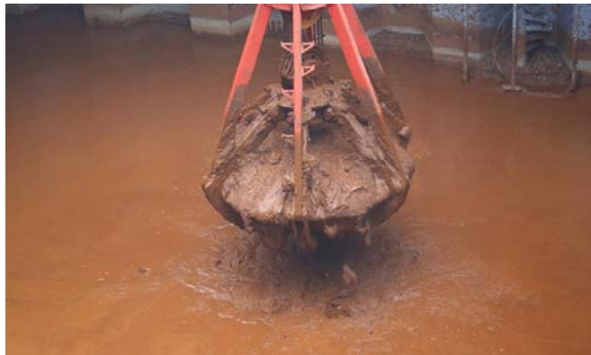
Slika 4. Posljedica nedozvoljenog postotka vlage na ukrcanom teretu željezne rude.
