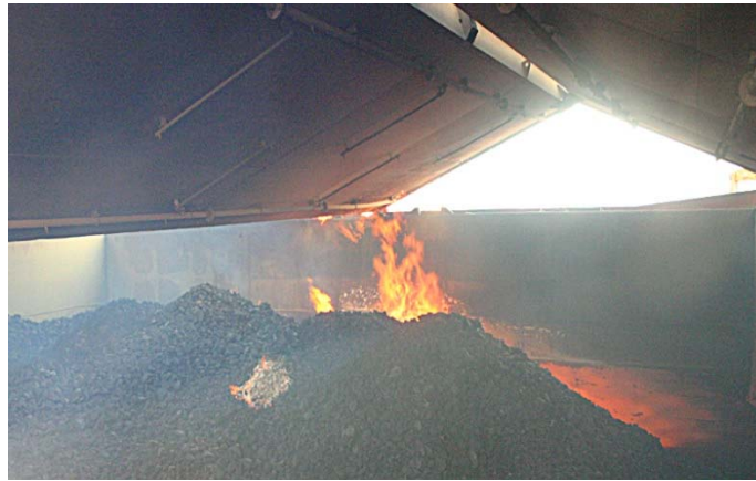
Slika 6. Samozapaljenje ugljena u brodskom skladištu.
