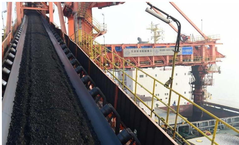
Slika 5. Proces ukrcaja termalnog ugljena na brod.
