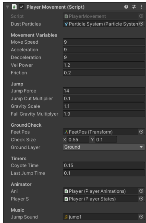
Slika 12 PlayerMovement skripta unutar Unity uređivača
