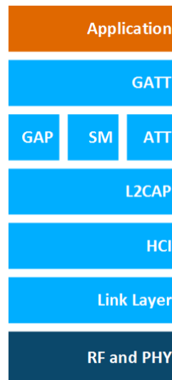
Slika 2. Bluetooth niskoenergetska arhitektura [5]
