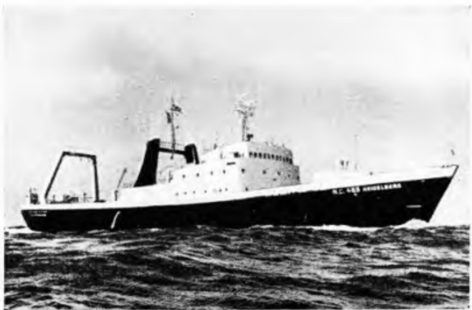
Slika 3. Kočar s krmenom rampom [10]
