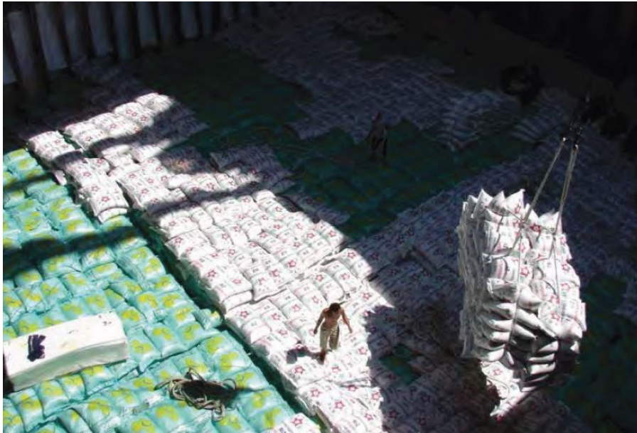
Slika 6. Prikaz ventilacijskih kanala prilikom ukrcaja riže.
