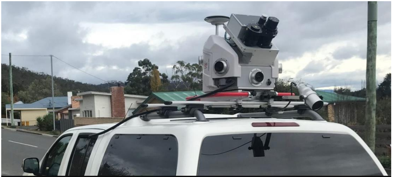
Slika 3. Primjer mobilnog MLS skenera [9]
