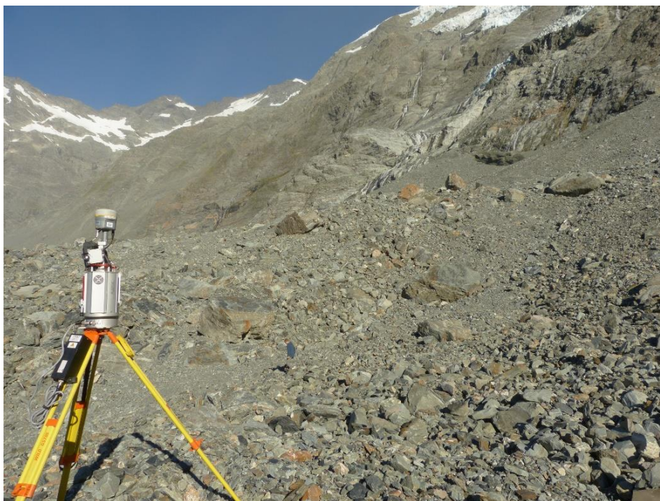
Slika 1. Primjer TLS skenera [7]
