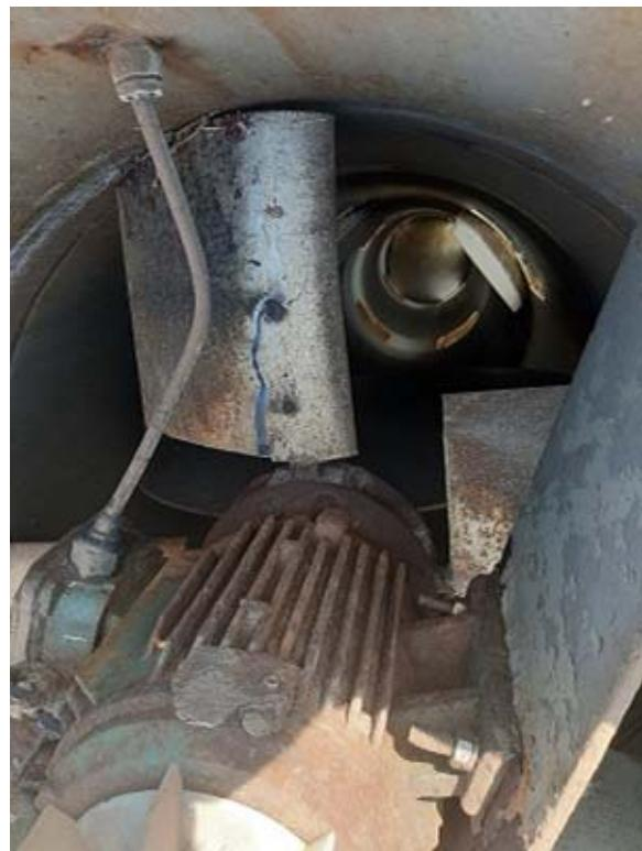
Slika 31. Prikaz puknuća impelera
