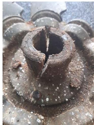
**Slika 30. Prikaz puknuća impelera**
