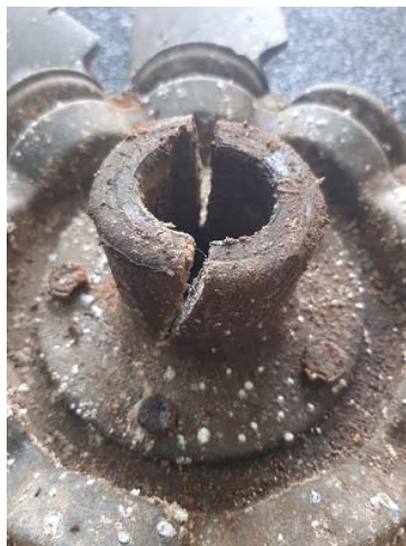
Slika 30. Prikaz puknuća impelera
