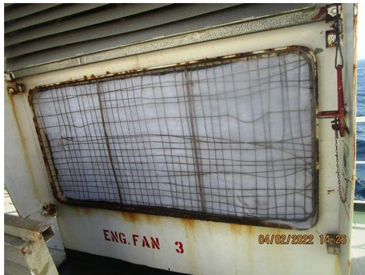
**Slika 16. Prikaz zaštite za ventilator**
