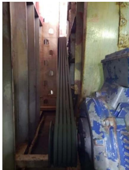
**Slika 11. Ventilator s remenim prijenosom [5]**
