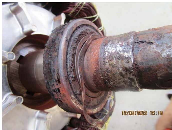
**Slika 38. Oštećeni ležaj**
