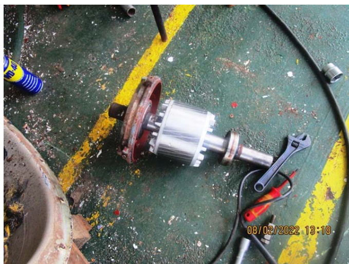
Slika 41. Rotor s promjenjenim ležajima
