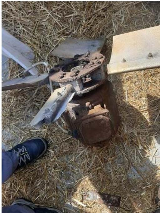
**Slika 33. Puknuće impelera**
