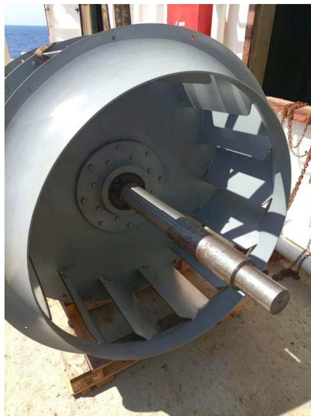
Slika 10. Centrifugalni ventilator [2]
