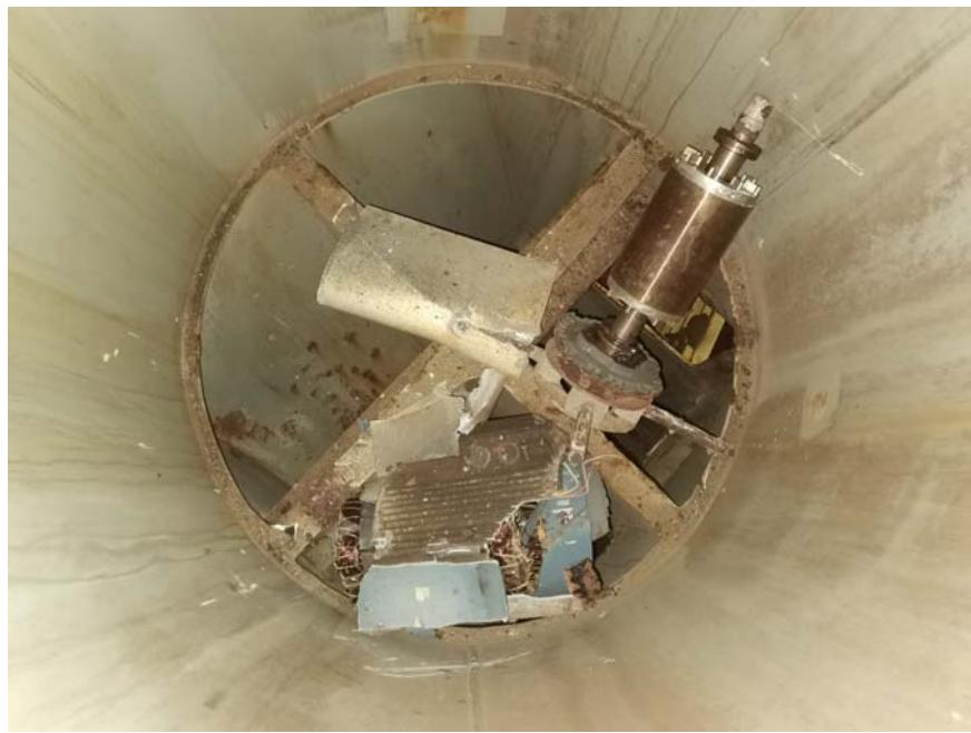
**Slika 35. Prikaz puknuća impelera i elektromotora**
