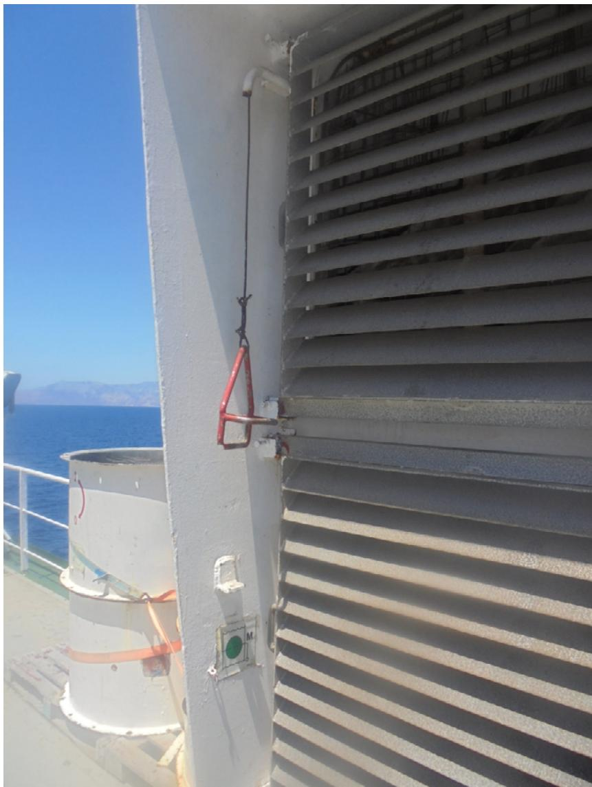
Slika 15. Prikaz ulaza zraka u ventilator za strojarnicu
