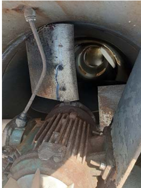
Slika 31. Prikaz puknuća impelera
