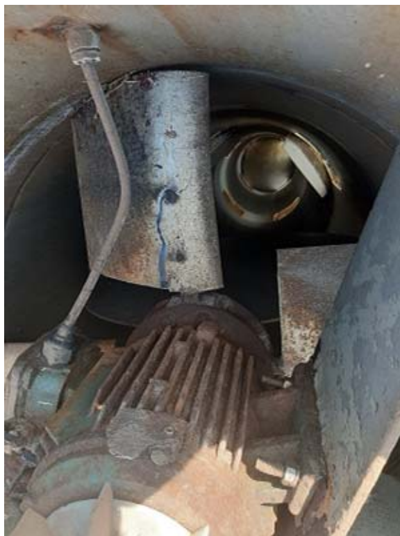
Slika 31. Prikaz puknuća impelera
