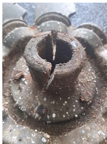
Slika 30. Prikaz puknuća impelera
