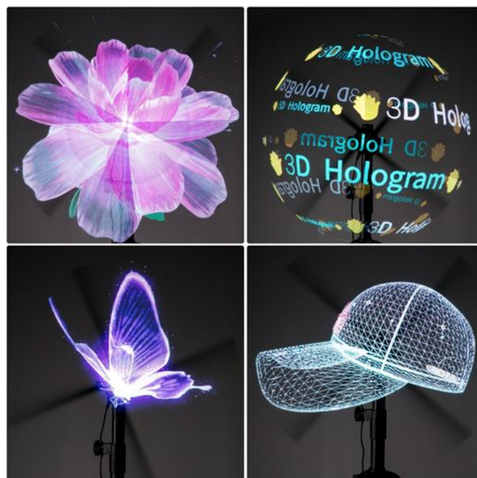
Slika 12 LED hologrami na bazi ventilatora [63]
