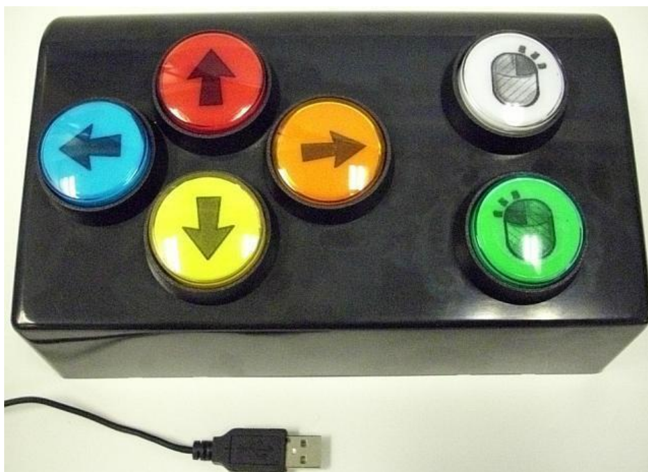
Slika 3 Računalni miš za osobe s motoričkim poteškoćama - Mouse-button box [62]
