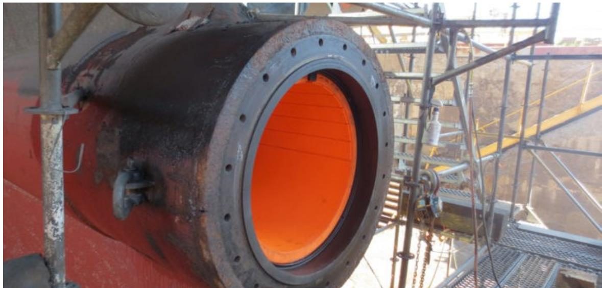
Slika 9. Thordon ležaj ugrađen na osovinskom vodu broda
