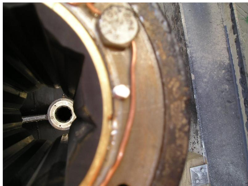
Slika 7. Ležajevi propelerne osovine
