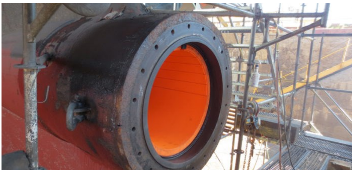
Slika 9. Thordon ležaj ugrađen na osovinskom vodu broda
