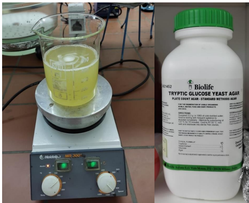
Slika 16. Prikaz pripreme Tryptic glucose yeast agar podloge.
