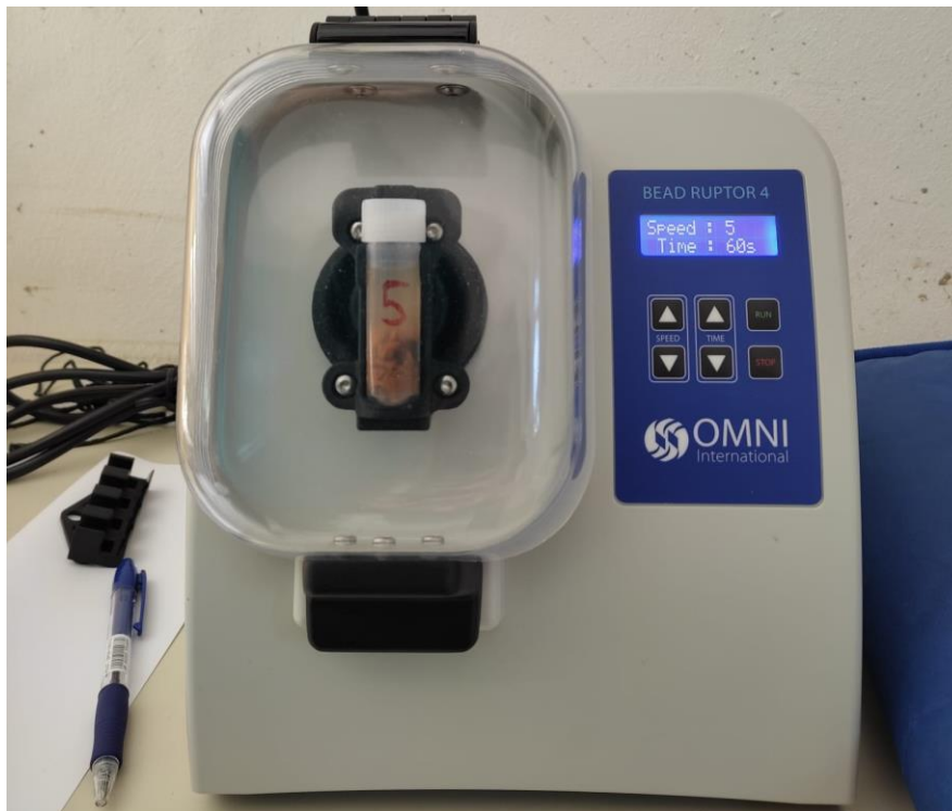
Slika 13. Homogeniziranje uzoraka u uređaju Bead ruptor (OMNI International).
