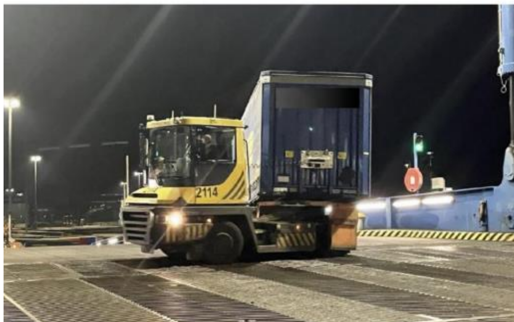
Slika 12. Terminalni tegljač koji utovaruje poluprikolicu
