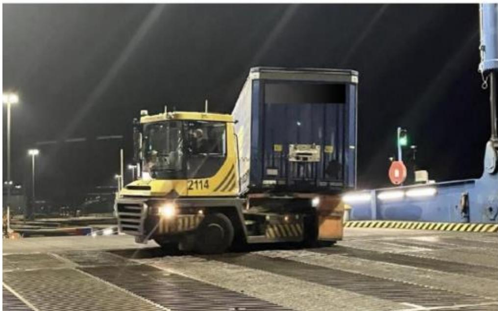
**Slika 12. Terminalni tegljač koji utovaruje poluprikolicu**
