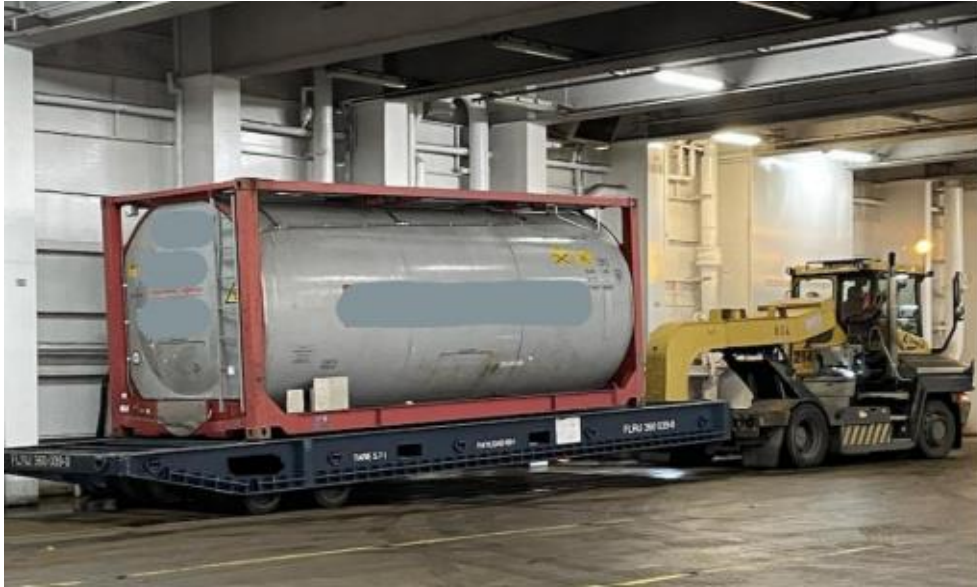
Slika 8. Poluprikolica za prijevoz tereta na RoPax plovilu
