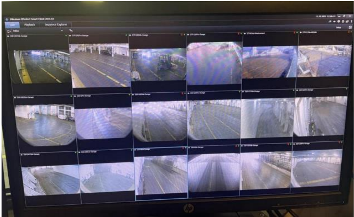
Slika 13. CCTV za praćenje utovara u stvarnom vremenu
