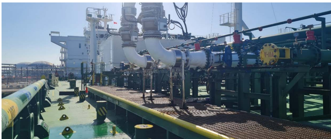
Slika 3. Prikaz palubnih priključak na LPG brodu; Izvor: arhiva autor
