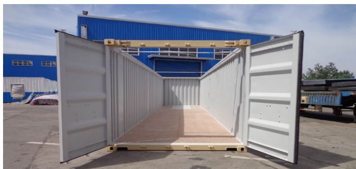
Slika 3. Kontejner bez krova.
