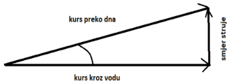
Slika 5. Metoda direktnog mjerenja morskih struja
