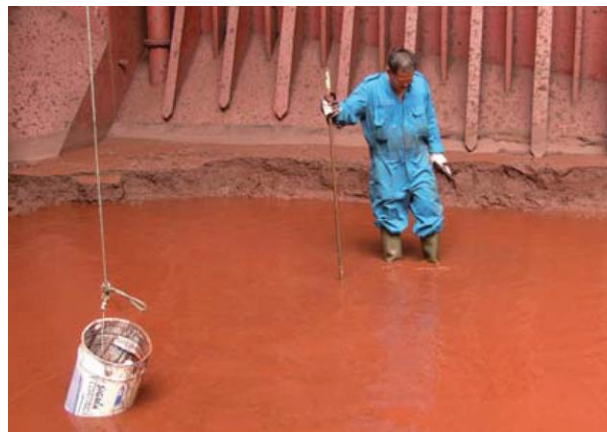
Slika 4. Rudača nikla nakon likvifikacije.
