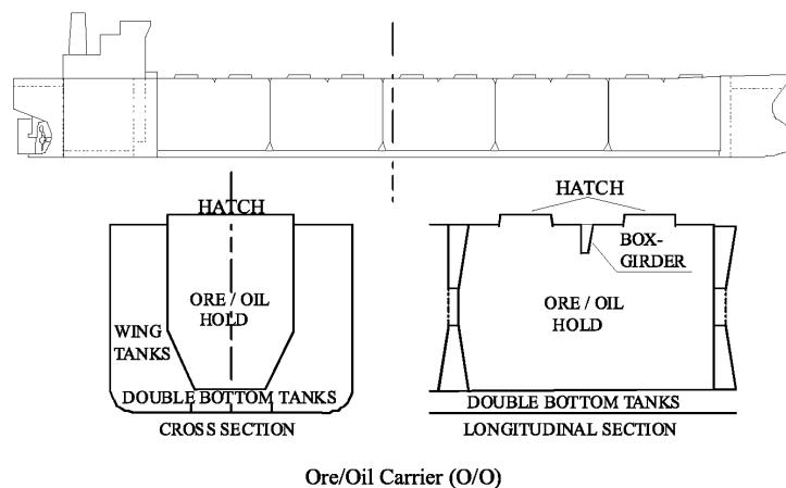
Slika 1. Poprečni i uzdužni presjek "bulkera" sa pet skladišta.
