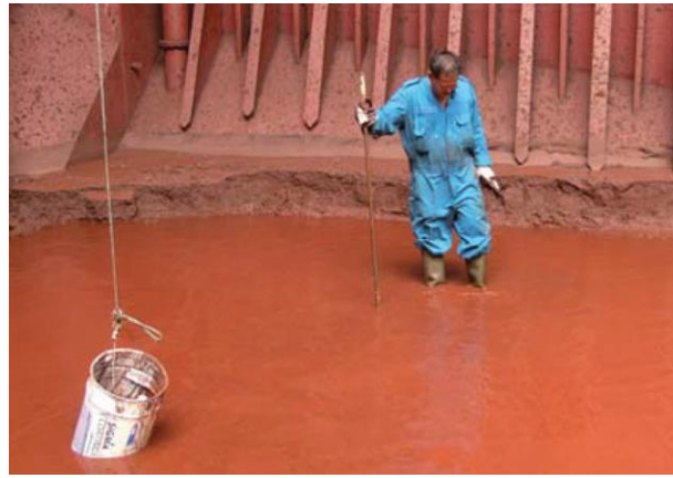
Slika 4. Rudača nikla nakon likvifikacije.
