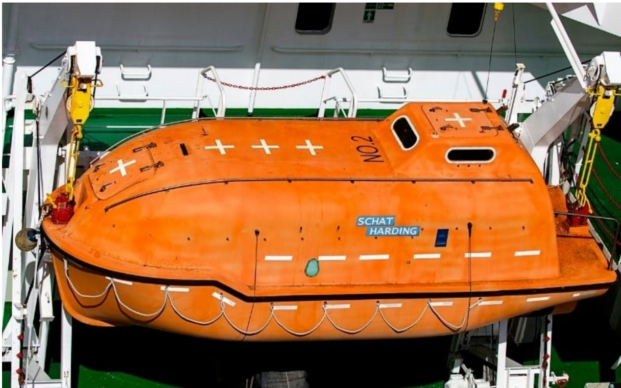
Slika 2.: Potpuno zatvorena brodica za spašavanje
