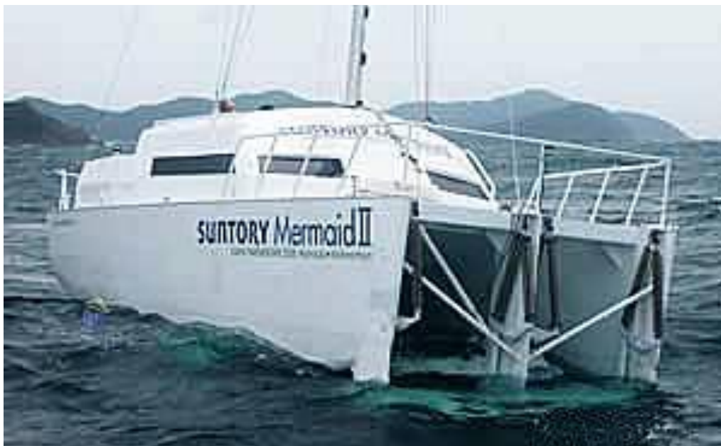
Slika 21. Katamaran koji iskorištava energiju valova 87
