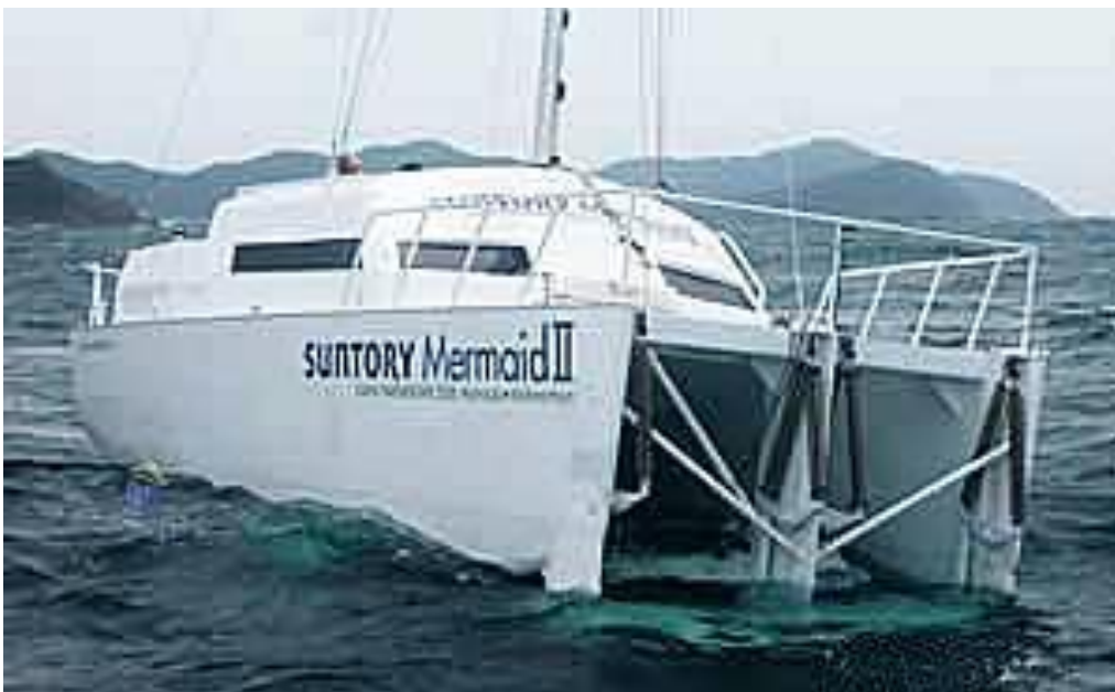
Slika 21. Katamaran koji iskorištava energiju valova 87
