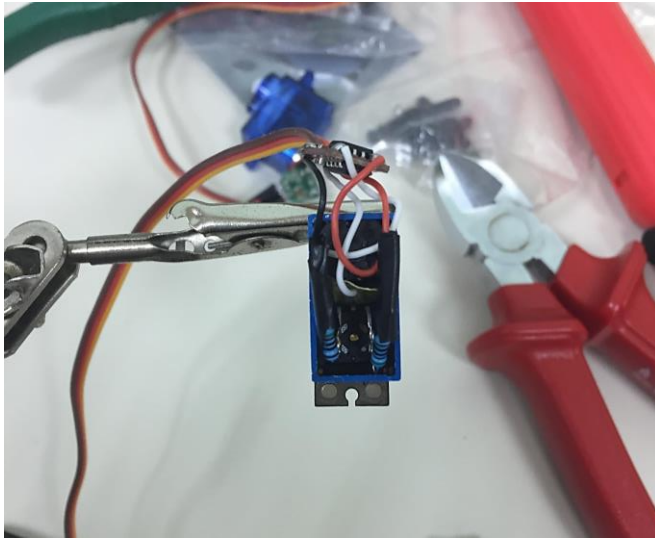
Slika 7.4 TowerPro MG92B servomotor s ugrađenim otpornicima
