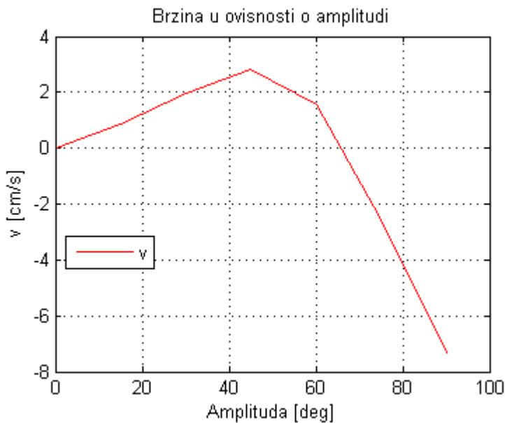
Slika 3.32 Brzina modula za  $\theta_s=60^\circ$
