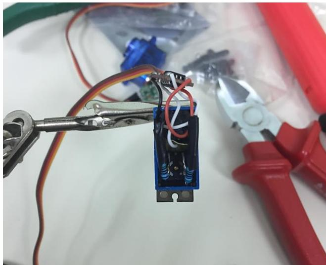
Slika 7.4 TowerPro MG92B servomotor s ugrađenim otpornicima
