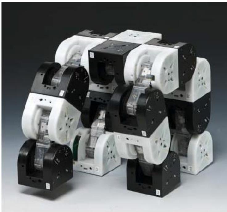
Slika 1.1IMTRAN III modularni robot [4]
