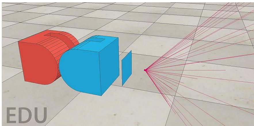
*Slika 6.2 Implementacija senzora za mjerjenje udaljenosti*
