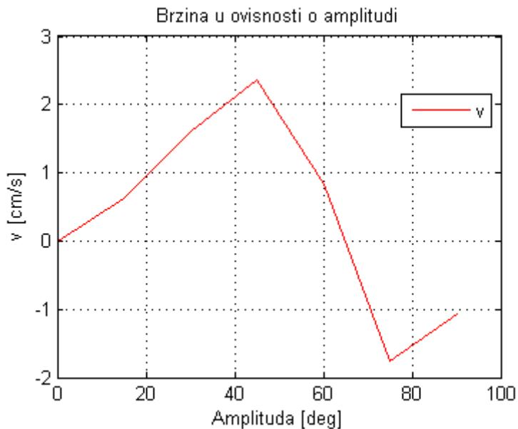
Slika 3.31 Brzina modula za  $\theta_s=45^\circ$
