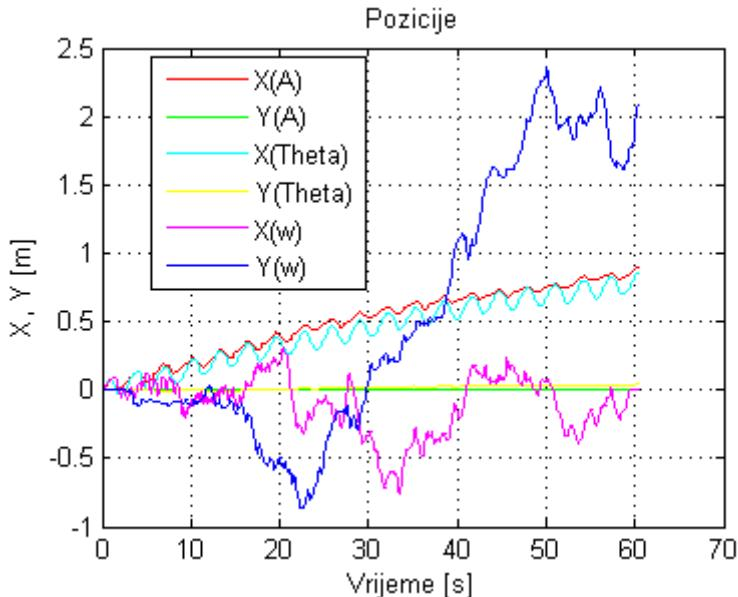
Slika 4.7 Pozicije modula za testirane regulatore uz  $K_p=0.5$  i  $K_i=0.5 + \text{anti-windup}$
