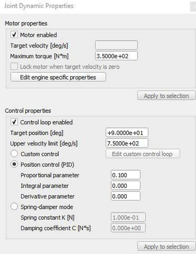
*Slika 3.7 Dinamički parametri glavnih aktuatora*
