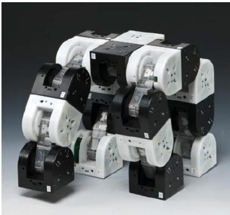
Slika 1. IMTRAN III modularni robot [4]
