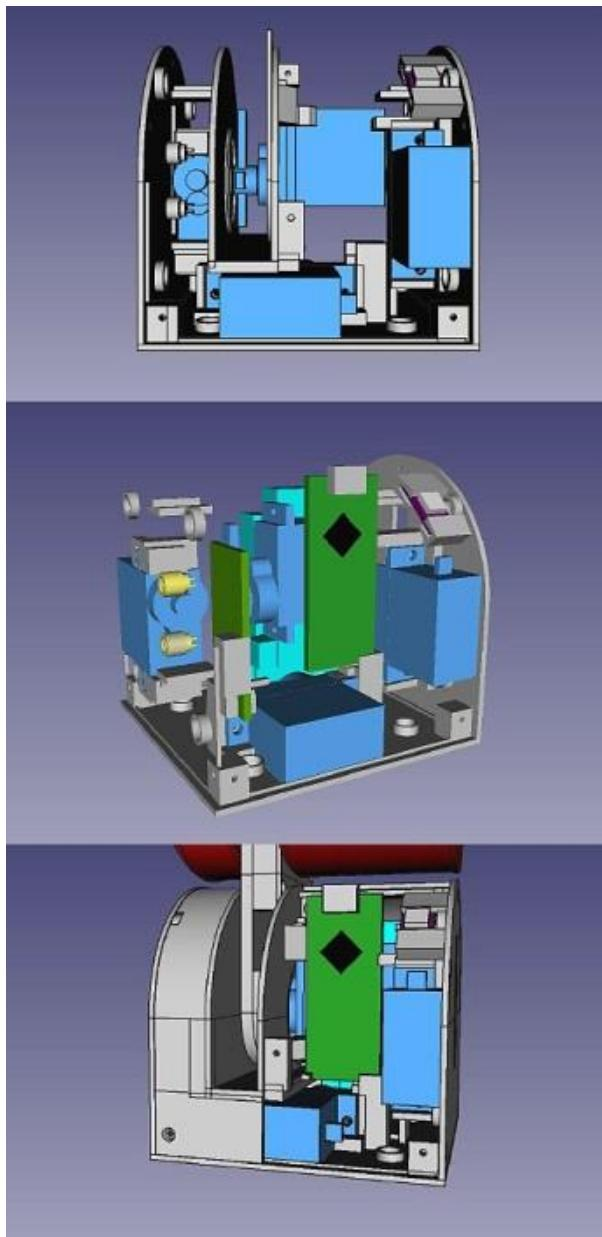
Slika 2.3 Unutrašnjost aktivnog segmenta DTTO v2 [6]
