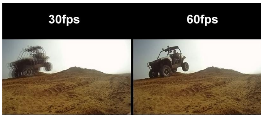
Slika 2.3 Razlika u frekvenciji izmjene slika.
