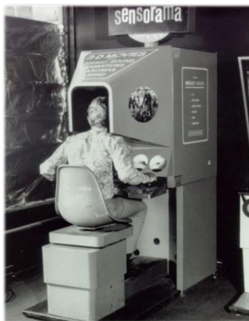
Slika 1.1 VR simulator Sensorama
