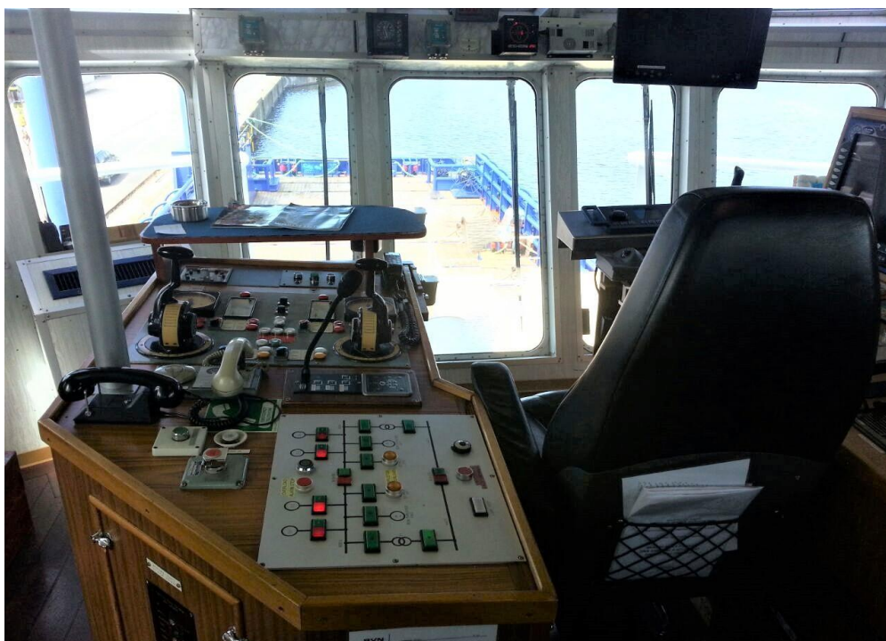
Slika 5: Krmeni dio mosta sa pogledom na DP centralnu konzolu i radnu palubu
