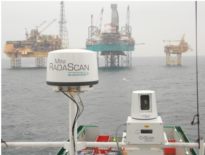
Slika 10: Laserska kupola CyScan sustav
