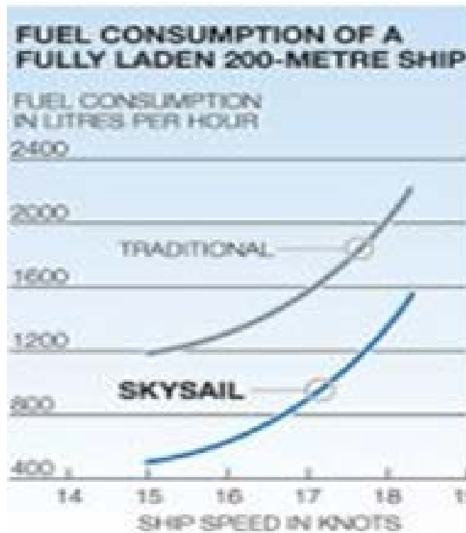
Slika 5. Usporedba potrošnje goriva kod broda s dizelskim porivom i dodanim zmajem [10].
