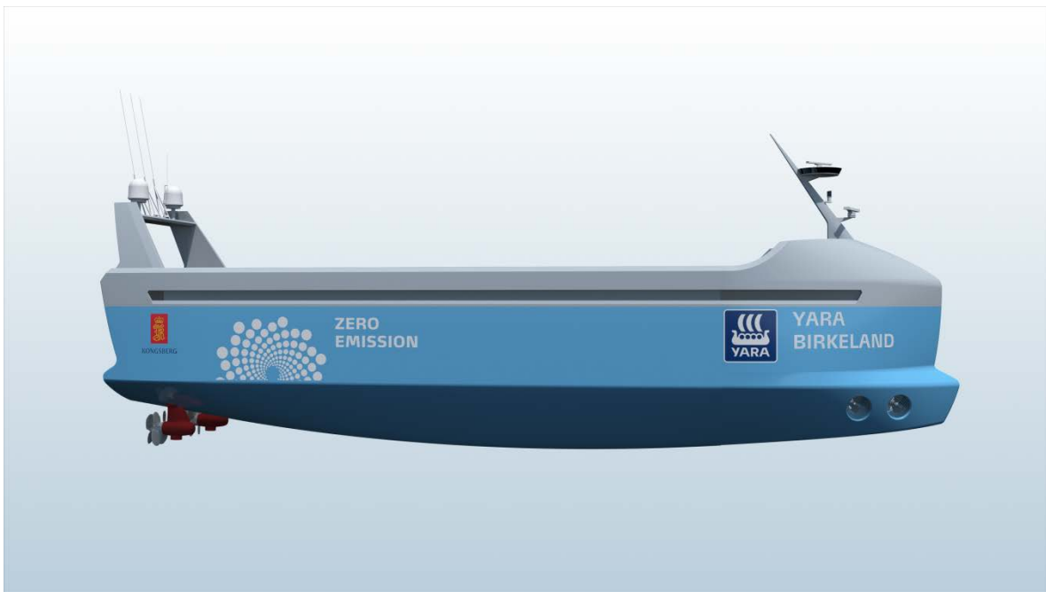
Slika 11. Projekt broda s akumulatorskim porivom [14].
