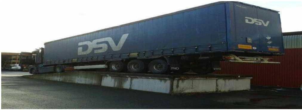
Slika 10. Kako se ne smije postaviti teretna prijevozna jedinica prilikom ukrcaja
