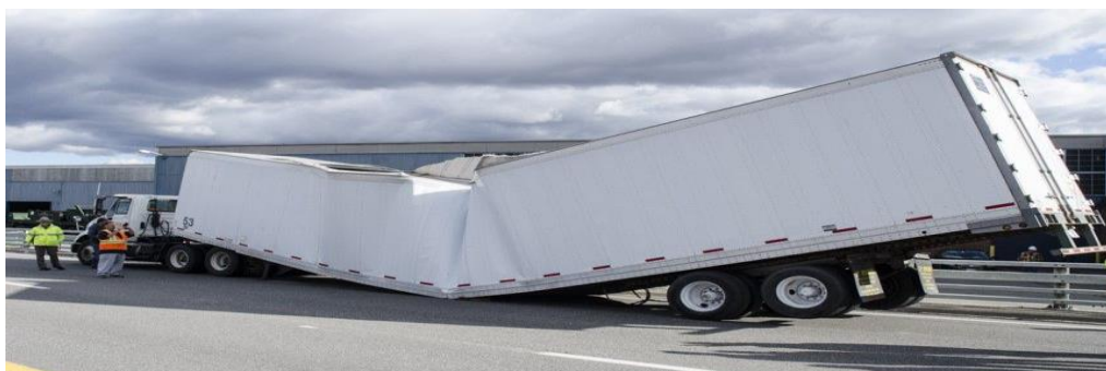
Slika 11. Nepravilno raspoređivanje tereta
