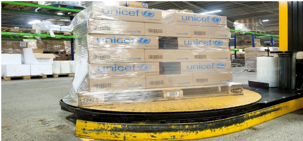
Slika 13. Osiguranje tereta na paleti sa polietilenskom folijom
