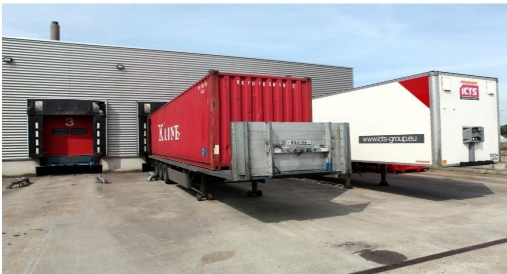
Slika 9. Prikazuje kako treba postaviti kontejner prije početka ukrcanja tereta
