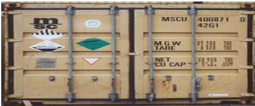
Slika 42. Kontejner sa oznakom o prijevozu opasnog tereta
