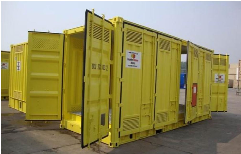
Slika 47. Izgled posebnog kontejnera za prijevoz opasnih tvari
