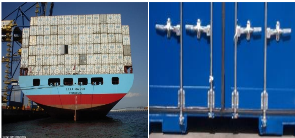
Slika 29. Neispravno zatvorena vrata(lijevo) ispravno zatvorena (desno)
