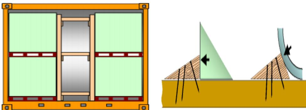
Slika 17. Umetanje paleta okomito za učvršćivanje tereta(lijevo),umetanje klinova za učvršćivanje cijevi(desno)
