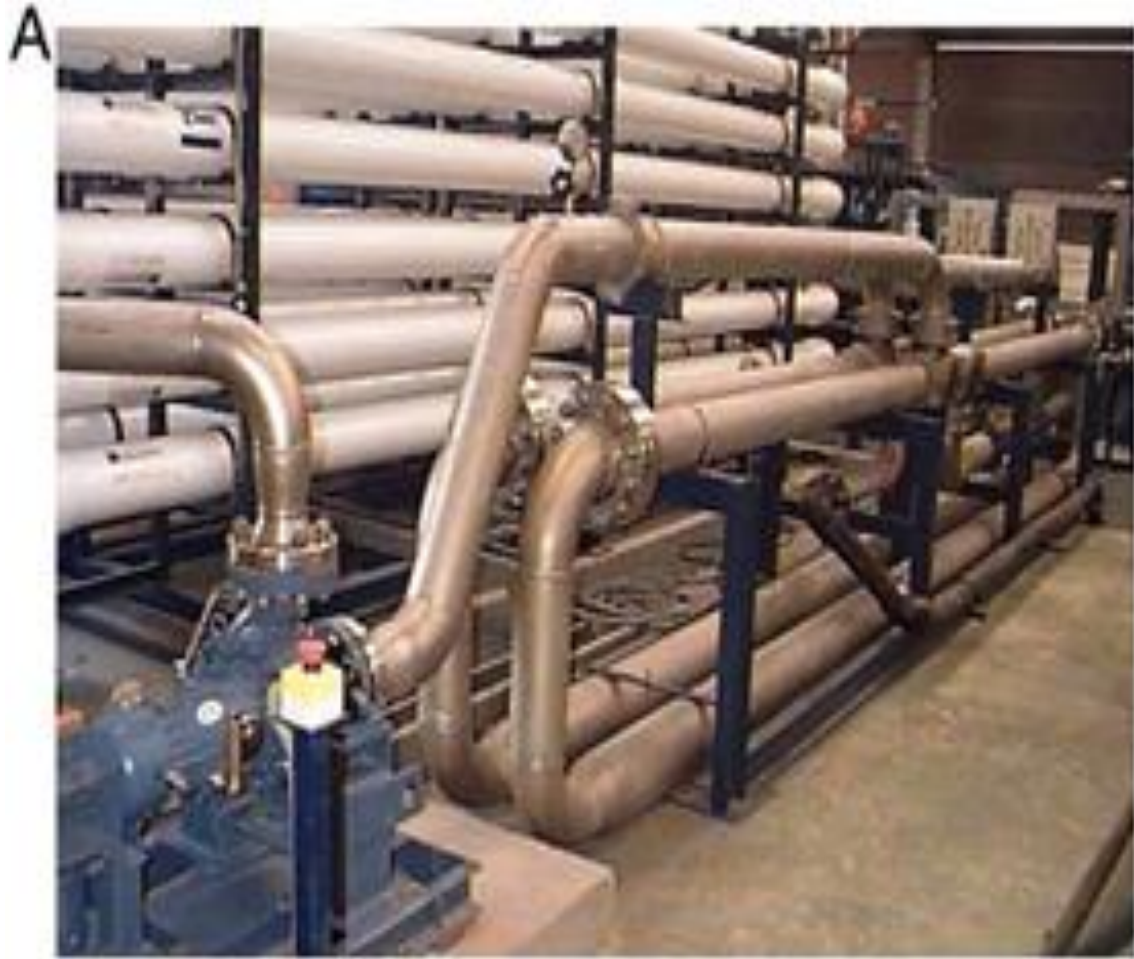
Slika 19: RO KinetiC® petlje. Izvor: M. Barreto.[6]
