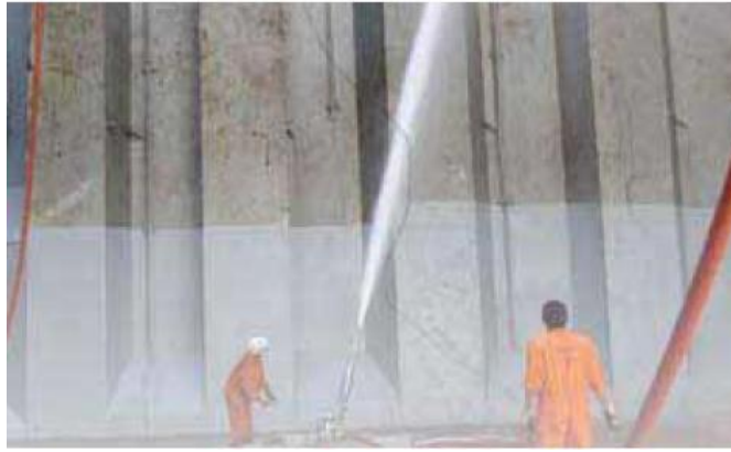
Slika 1. Pranje ostataka tereta u skladištu
