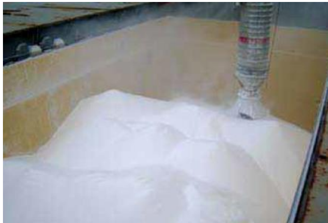
Slika 46. Ukrcaj natrijev karbonata (SODA ASH) u skladišta sa dobrim stanjem boje
