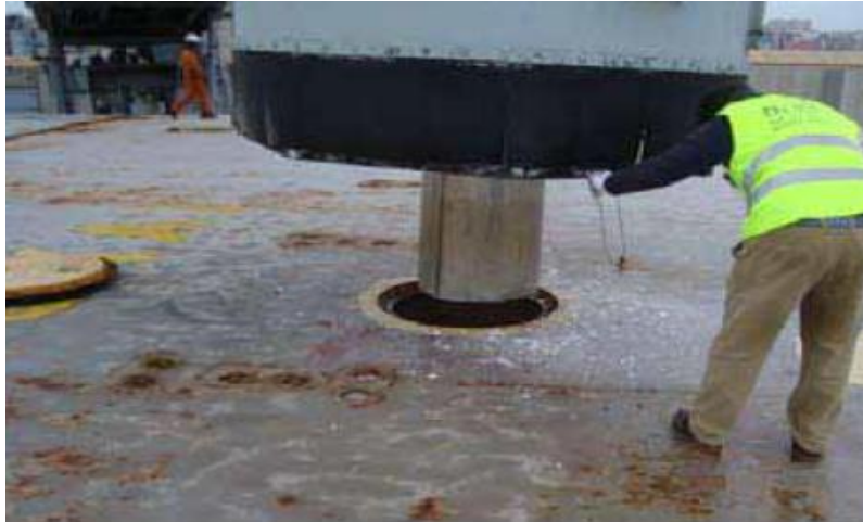
Slika 47. Ukrcaj natrijev karbonata(SODA ASH) kroz manje otvore na poklopcima skladišta tokom lošeg vremena
