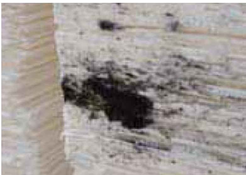
Slika 14. Pulpa sa mrljama od PETCOKE
