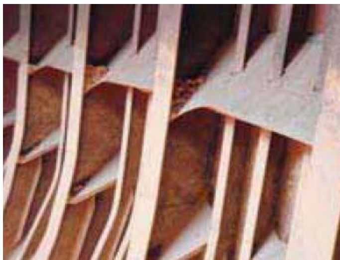
Slika 13. Ostaci prijašnjeg tereta rudaće, zaglavljenim u rebrima
