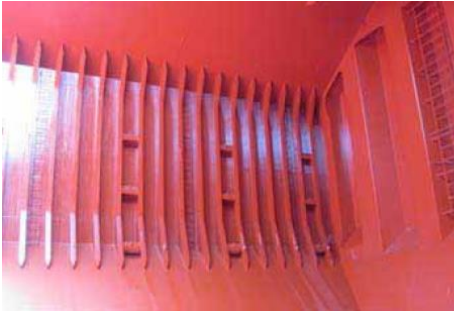
Slika 52. Bolnički čisto (Hospital clean) skladište
