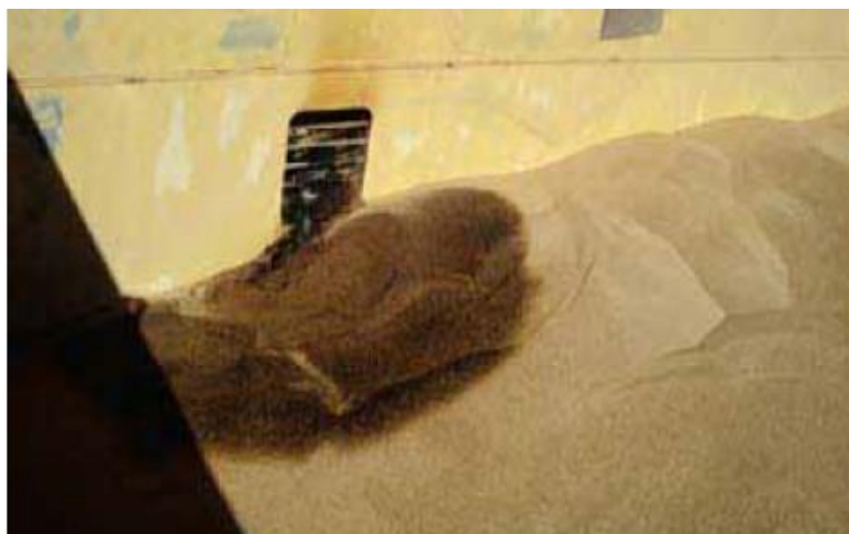
Slika 8. Svjetla u skladištima mogu prouzročiti požar
