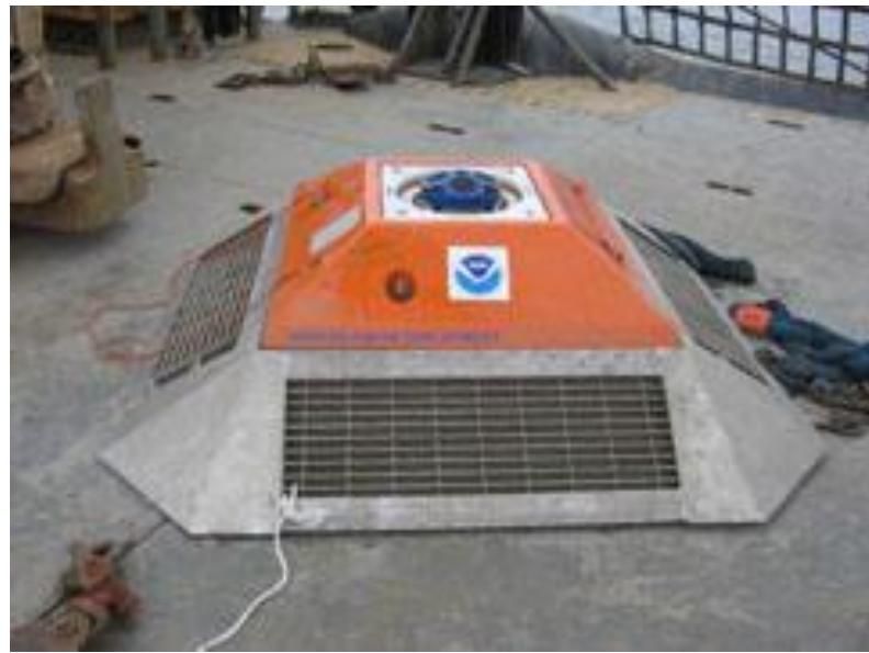
Slika 10. Izgled instrumenta koji radi na Dopplerov efekt; Izvor:
