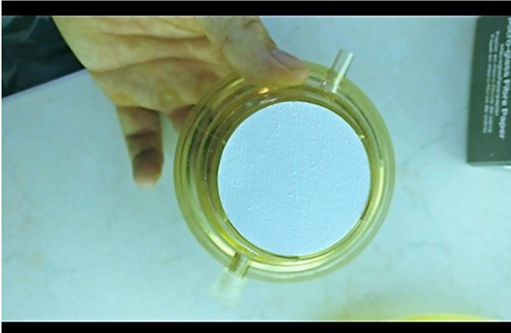
Slika 10. Munktell filter papir (veličina pora 0,45 \mu\text{m} ) postavljen na filteru.
