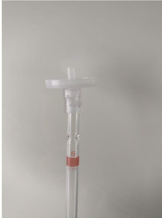
Slika 13. Postavljanje aeracije za tikvice od 5 l.
