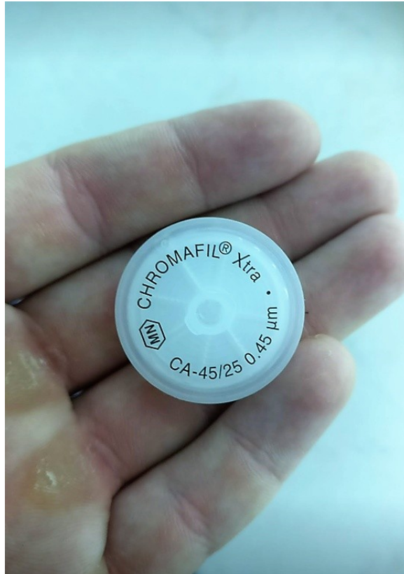
Slika 12. Filter za zrak koji se koristio za aeraciju tikvica od 5 l.
