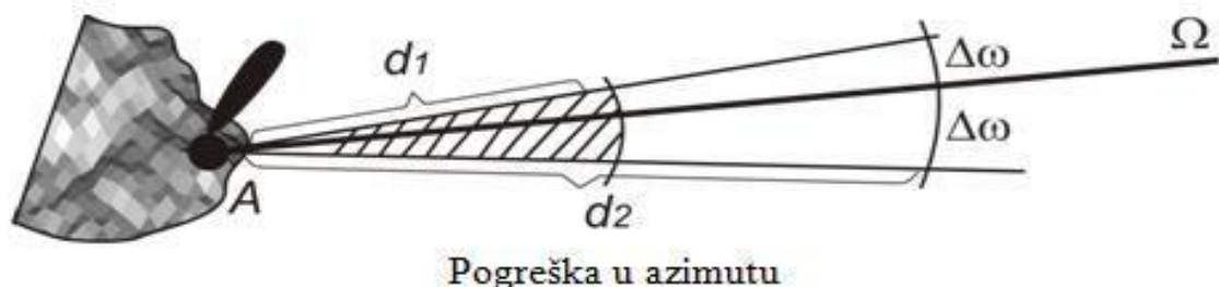
Slika 26. Pogreška u azimutu
