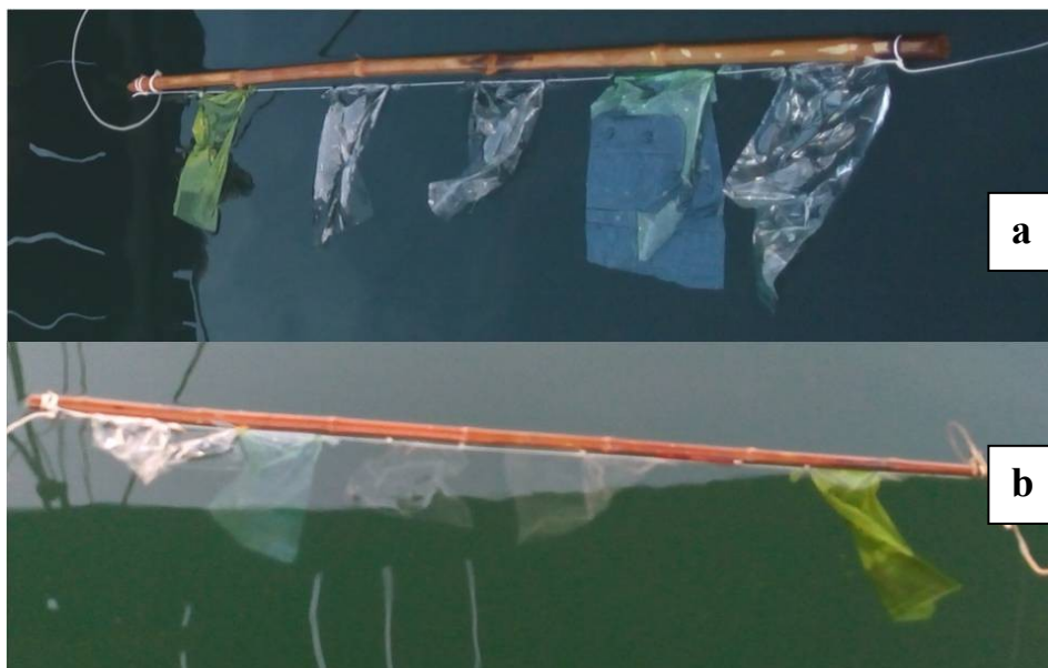
Slika 7. Eksperiment in situ , (a) plastika pluta, (b) plastika je potonula
