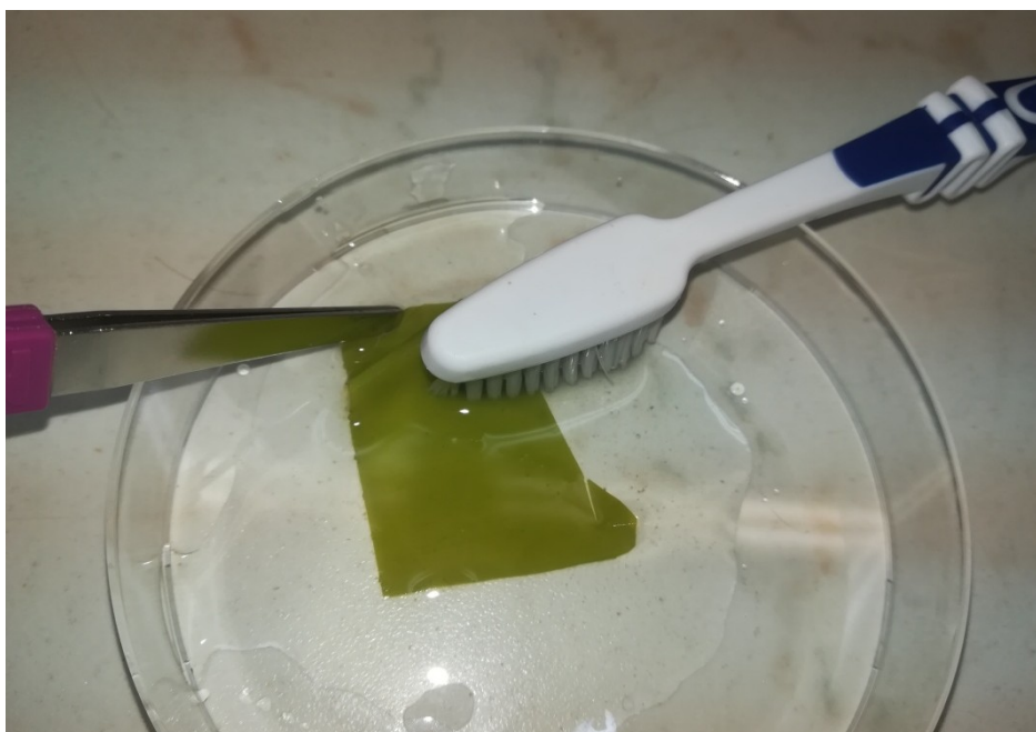
Slika 9. Skidanje obraštaja s plastike
