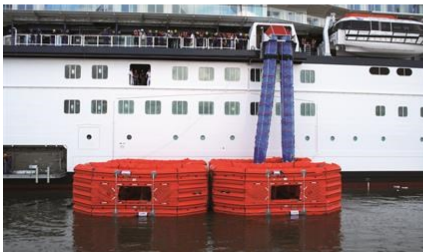
Slika 7. Sustavi za brzo napuštanje broda-pneumatski tobogani
