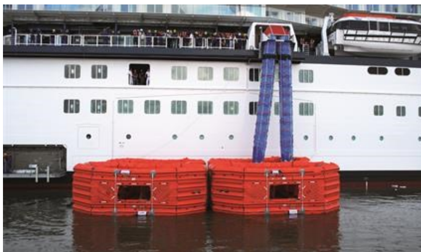
Slika 7. Sustavi za brzo napuštanje broda-pneumatski tobogani
