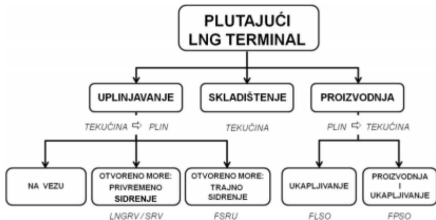
Slika 2. Plutajući LNG terminal – moguće primjene
