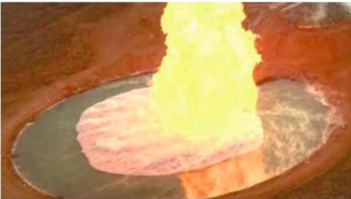
Slika 8. Požar lokve LNG-a [15]
