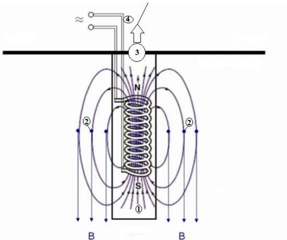
Slika 6. Senzor elektromagnetskog brzinomjera
