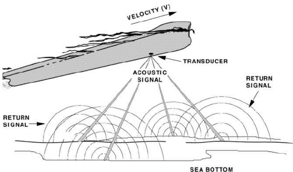
Slika 9. Princip rada Dopplerovog brzinomjera i Janus konfiguracije
